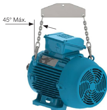
Figura 8 - Ângulo máximo resultante para motores com dois ou mais olhais de içamento.
