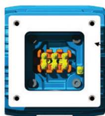
Figura 51 - Superfície usinada da caixa de ligação do motor à prova de explosão.
