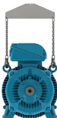
Figura 11 - Uso de barra separadora en el izamiento.
