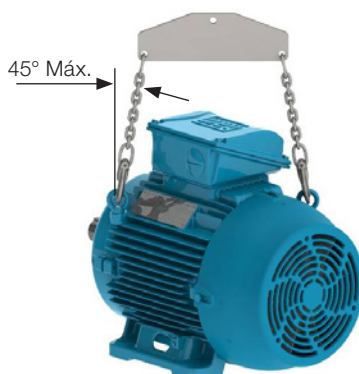
Figura 8 - Ángulo máximo resultante para motores con dos o más ojales de izamiento.
