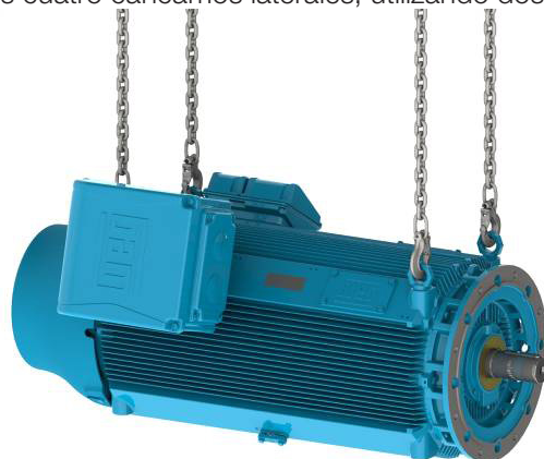
Figura 17 - Elevación del motor HGF, W50 y W51 HD utilizando dos grúas
